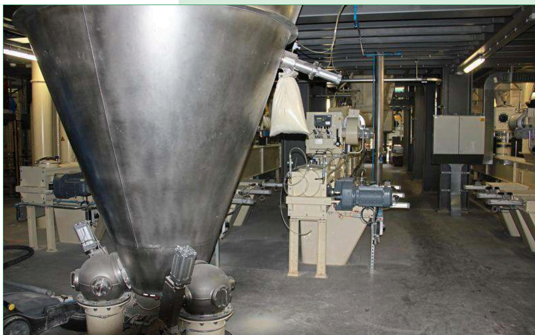
Der Mischer der X-Linie homogenisiert und standardisiert Rückläufer aus den Lebensmittelindustrie. The mixer of the X line homogenises and standardises returns of the Food industry.
